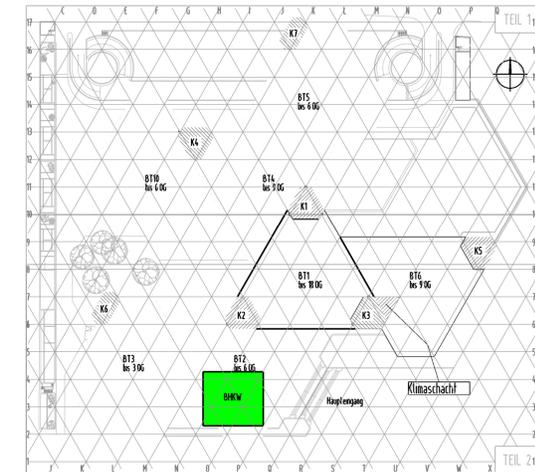
2xBLOCKHEIZKRAFTWERK / ETW  $Q_{max} = 867KW$
